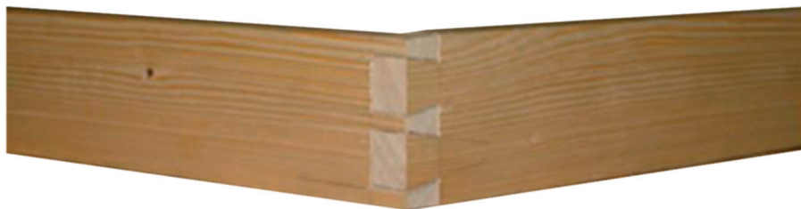
Obrázek 5 Ukázkou cvičné práce v oboru truhlář – zhotovení rohového konstrukčního spoje (otevřené ozuby), obor truhlář. Foto – Kovář, 2011, s. 50
