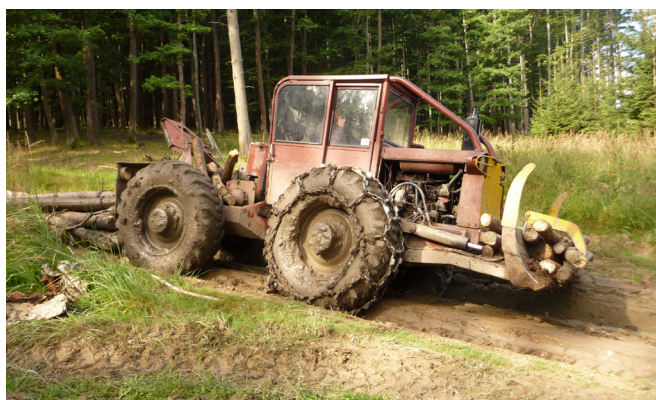
Obr. 47: Lesní kolový traktor (LKT), známý jako lakatoš (autor Pavel Ševela / Wikimedia Commons, dostupné z https://commons.wikimedia.org/wiki/File:Lakato%C5%A1,_Ond%C5%99ejovsko_(3).jpg ).
