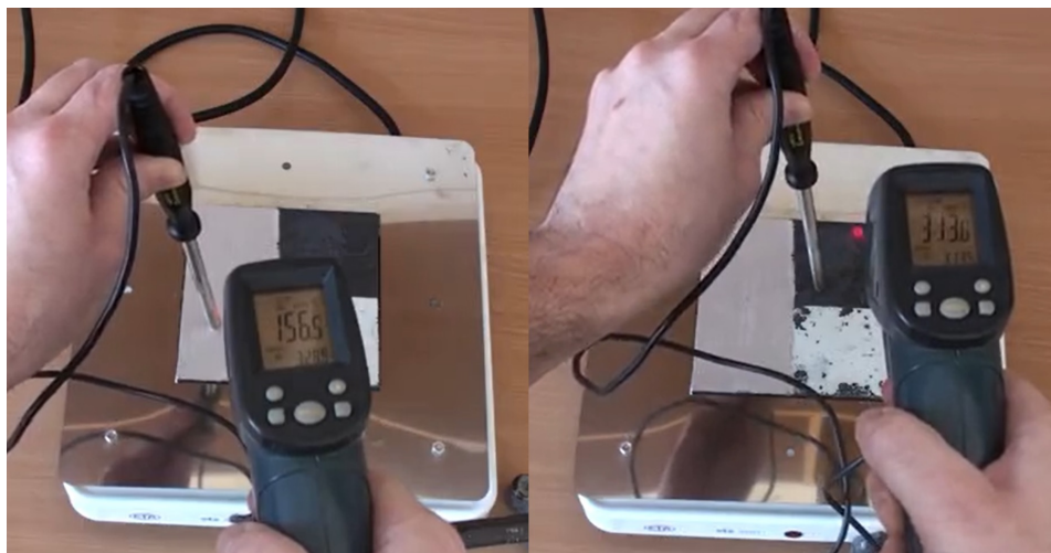
Obrázek 2. Ukázka z videozáznamu k porovnání měření teploty černého a lesklého povrchu pomocí kontaktního a infračerveného teploměru (cílem úlohy bylo určit emisivitu obou povrchů)
