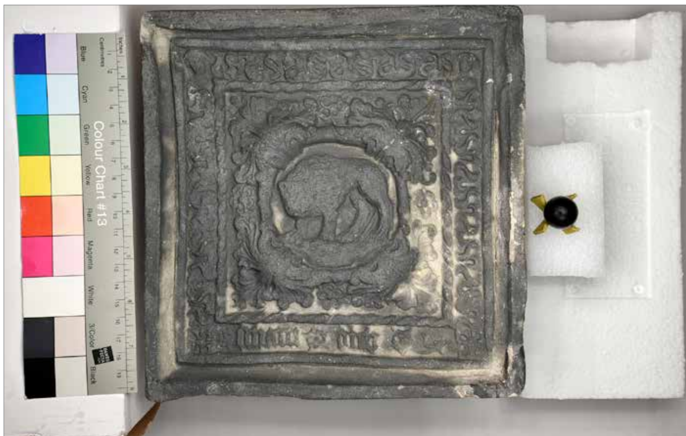
Obr. 9. Snímkovací prostor pro metodu RTI. Barevná škála – artefakt – referenční marker.
