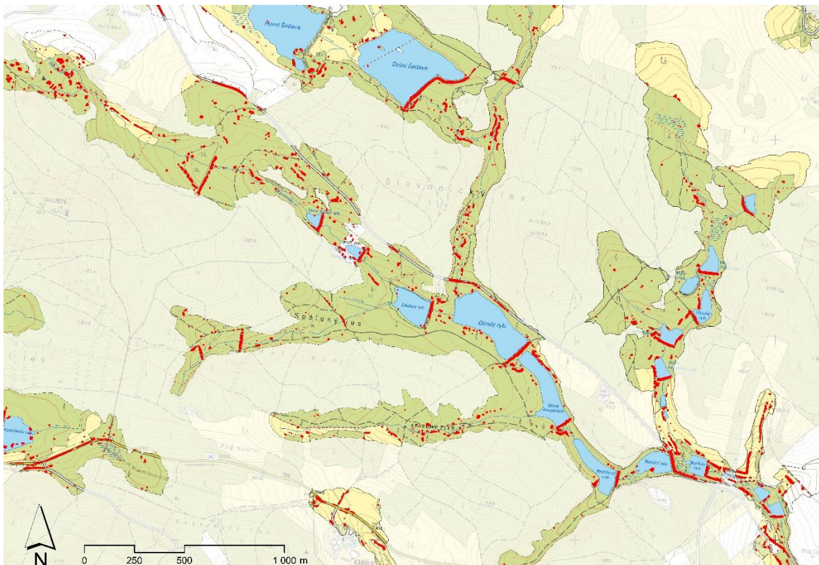
Obr. 9: Výsledná vrstva predikce možných hrází, která vznikla kombinací předchozích vrstev, autor RokLAB (VVS Panská Lhota).
