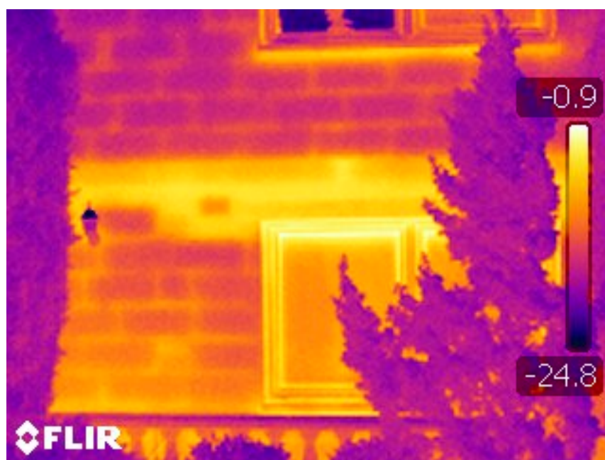
Obrázek 8.10: Termogram pro zjištění tepelných mostů stavby.
