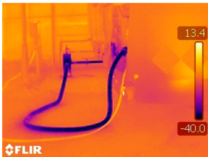
Obrázek 8.11: Termogram doplňování zásobníků dusíku.
