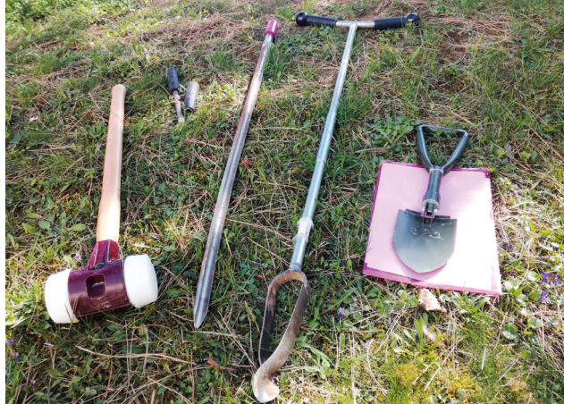
Zleva: perlik, sonda pro odběr půdního profilu, půdní vrták, polní lopatka
